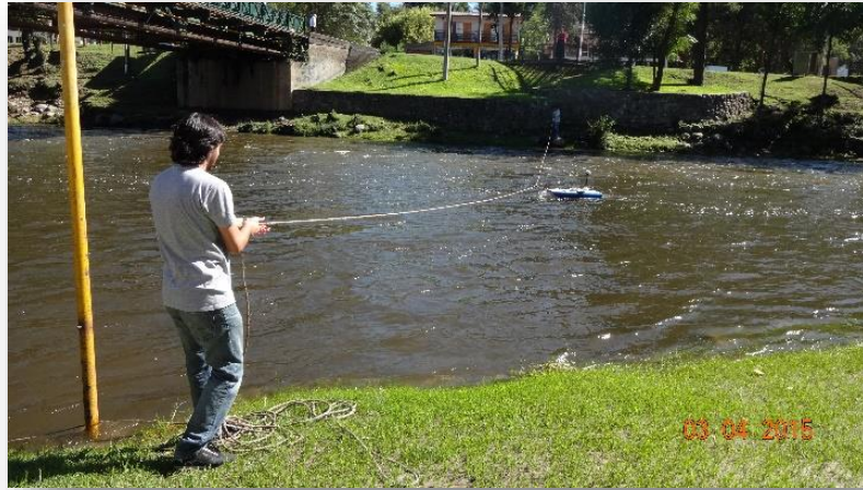
Figura 6: Medición ADCP en el río Santa Rosa el día 04/03/2015
